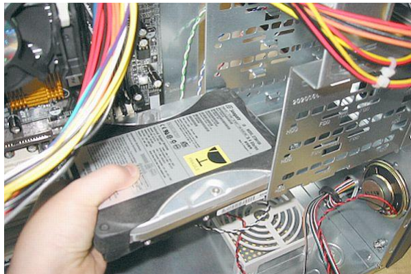
Hình 7.8. Lắp đặt ổ đĩa cứng
