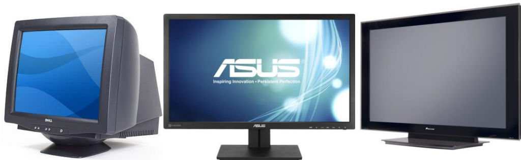
Hình 6.7. Các loại màn hình CRT, LCD và PLASMA
