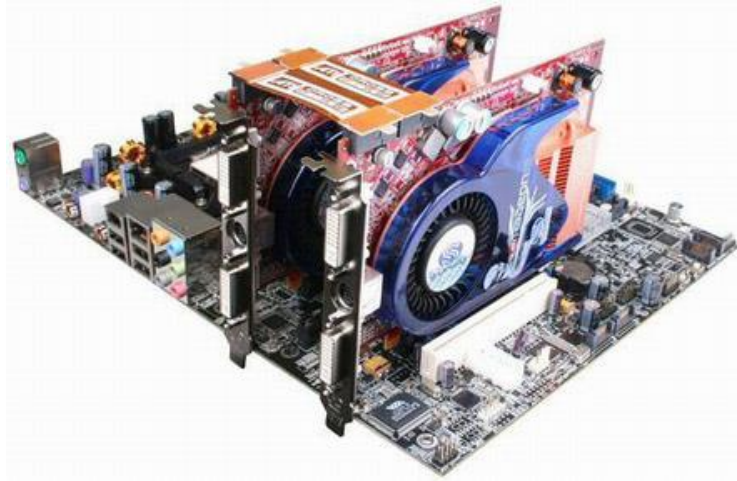
Hình 2.18. Công nghệ Dual Graphics sử dụng 2 Card đồ họa
