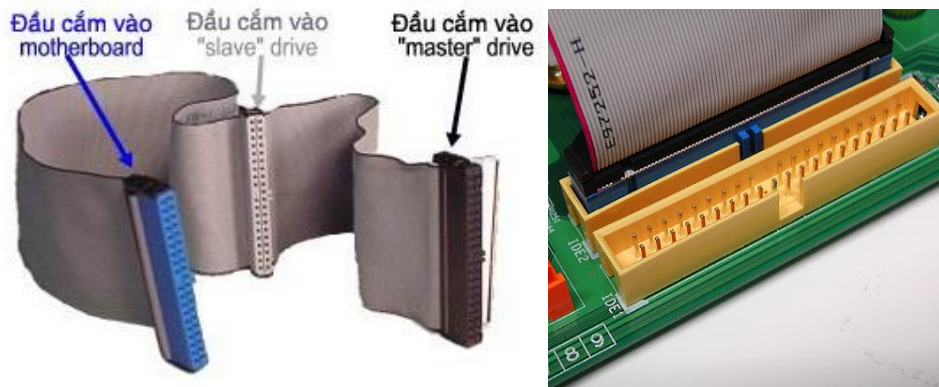
Hình 5.4. Cáp ATA và đầu nối vào mainboard
