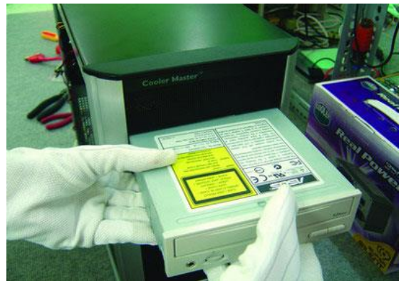
Hình 7.10. Lắp đặt ổ đĩa quang
