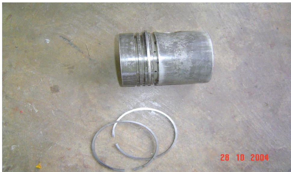
Hình 3.11 b cách lắp đặt xéc măng
