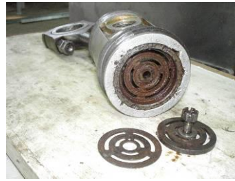
Hình 3.8 Cấu tạo của bộ van hút và piston
