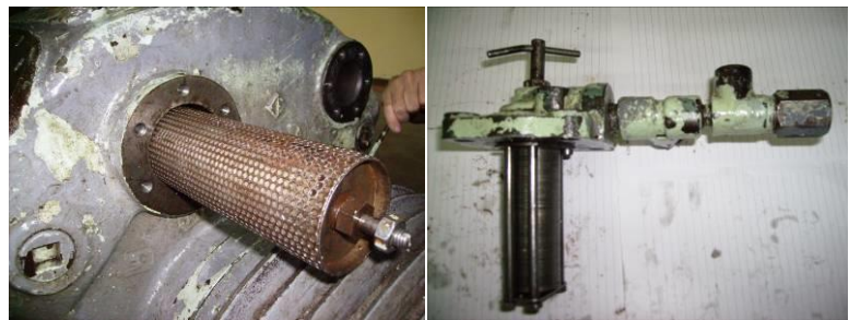
Hình 14: lọc môi chất và lọc tinh dầu
