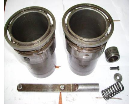
Hình 7: Cấu tạo xilanh có bộ giảm tải
