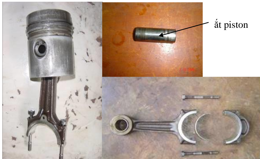
Piston trước và sau khi tháo Ắt piston và thanh truyền ra khỏi
