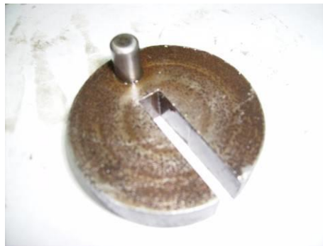
Hình 12: Bộ phận truyền động của bơm dầu
