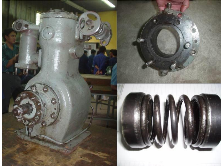
Bộ đệm kín trục kiểu hộp xếp tĩnh
