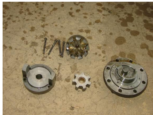
Hình 12: Các chi tiết của bơm dầu
