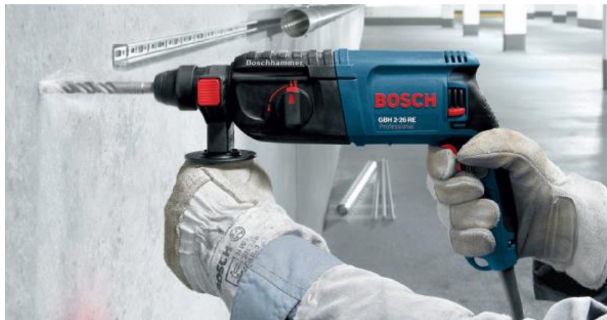
Hình 2.10. Sử dụng khoan trong môi trường đầy đủ ánh sáng.
