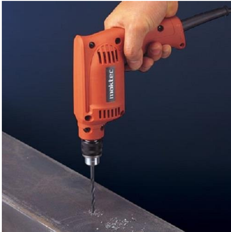
Hình 2.11. Sử dụng khoan đúng kỹ thuật.
