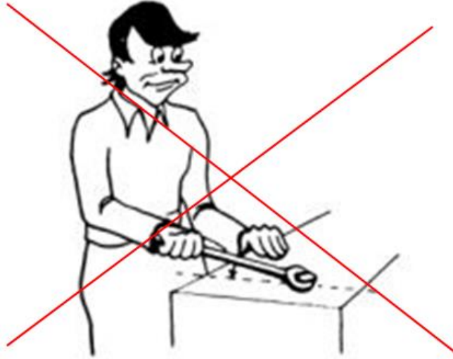
Hình 1.72. Không được để kềm, hoặc nghiêng cờ lê đầu mở.
