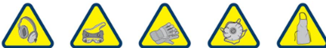
Hình 2.19. Sử dụng các trang bị bảo hộ khi làm việc với máy mài.
