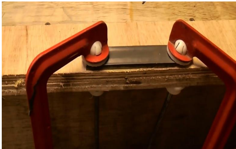
Hình 2.13. Cố định chắc chắn vật cần khoan.
