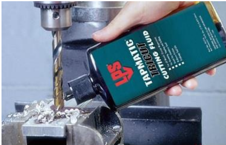
Hình 2.15. Làm mát mũi khoan khi khoan.
