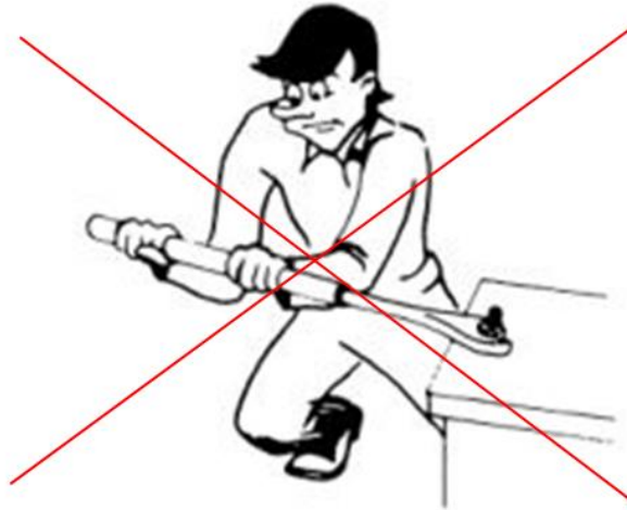
Hình 1.70. Không được phép sử dụng thanh nối dài cờ lê hay mỏ lết.
