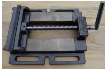
Hình 1.15. Ê tô bàn khoan.
