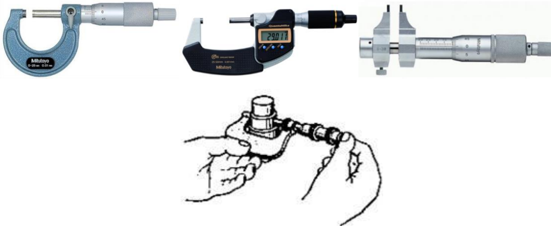
Hình 1.3. Pan me và cách đo bằng Pan me.
