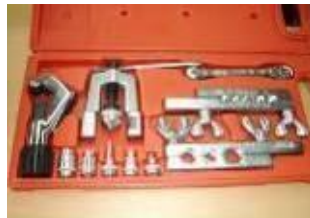
Hình 11.4: Bộ loe, cắt, núc ống đồng.
