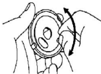
Hình 6.12 Kiểm tra mâm chia điện.
