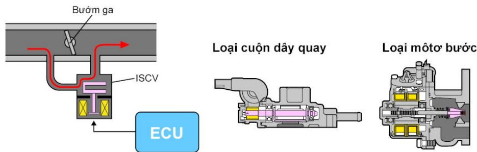
Hình 2.14. Van ISC loại điều khiển đường đi tắt
