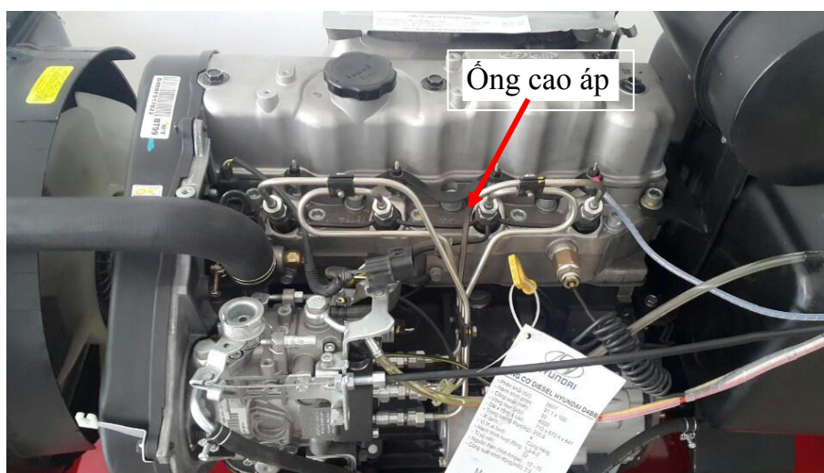
Hình 1.32. Đường ống cao áp của động cơ diesel Hyundai
