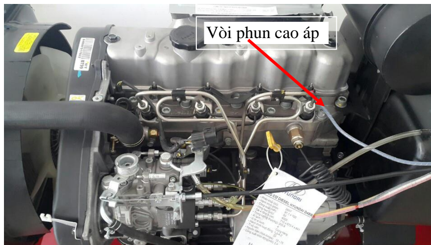
Hình 1.34. Vòi phun cao áp của động cơ diesel Hyundai
