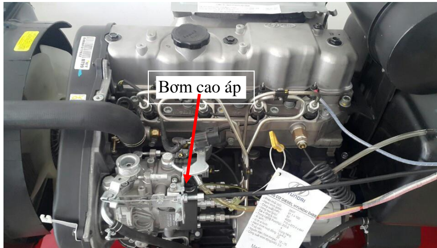
Hình 1.33. Bơm cao áp của động cơ diesel Hyundai
