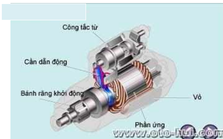
Hình 8. 3: Cấu tạo máy khởi động điện
