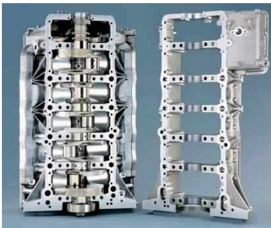
Hình 2.2: Thân máy của động cơ đốt trong
