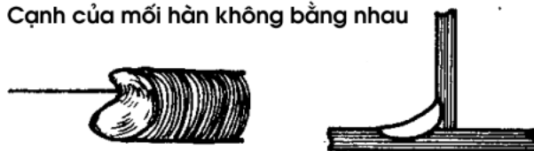
Hình 2.42. Đường hàn đều và không đều
