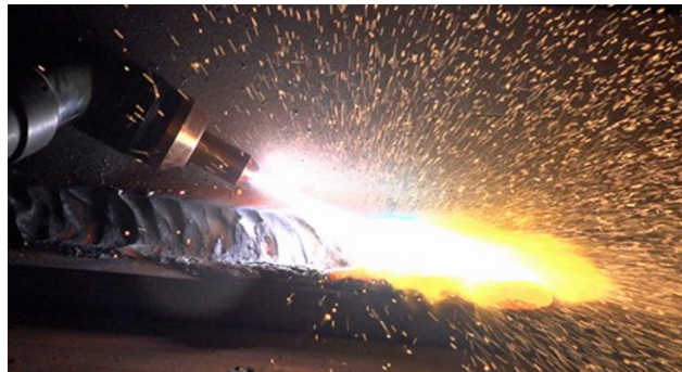
Hình 1.3. Sự bắn tóe của kim loại nóng chảy và xỉ hàn
