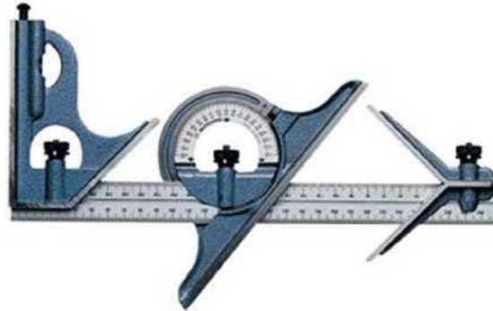
Hình 3.15. Thước đo góc vạn năng b. Cấu tạo
