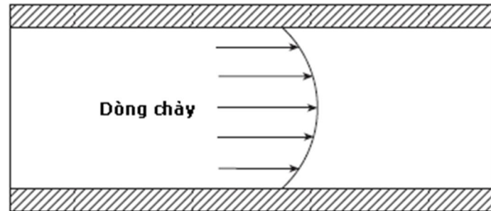
Hình 3.4: Vận tốc dòng chảy với ảnh hưởng của tính nhớt và lực ma sát
