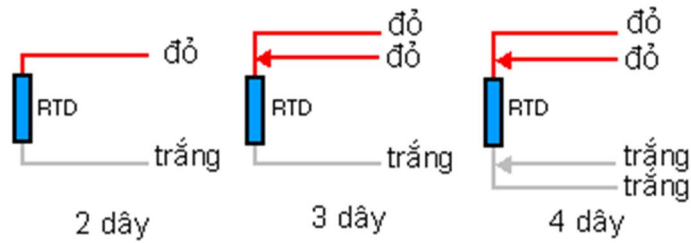
Hình 1.3 Cách nối dây nhiệt điện trở
