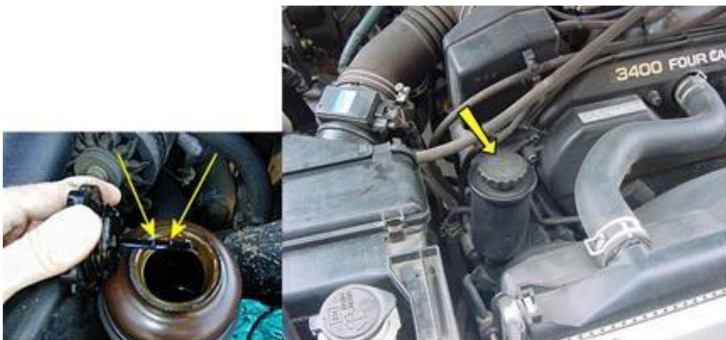
Hình 1.21. Bình chứa dầu trên xe hơi
