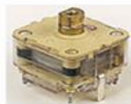
Hình 2.27: Hình ảnh tụ có điện dung điều chỉnh được
