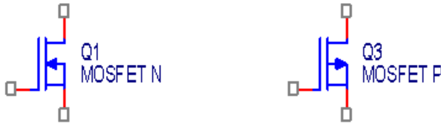
Hình 3.42: Kí hiệu quy ước của MOSFET kênh N và kênh P
