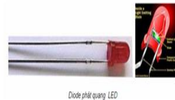
Hình 3.9 : Hình ảnh diode phát quang
