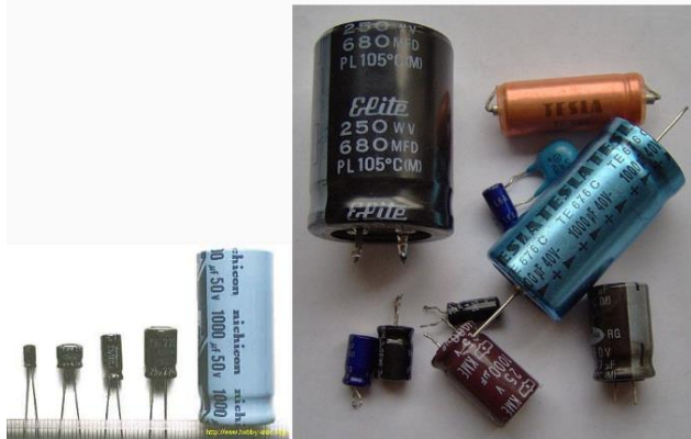
Hình 2.26: Hình ảnh tụ hóa
