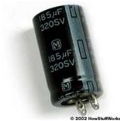
Hình 2.29 : Tụ hoá ghi điện dung là 185 \mu\text{F} / 320 V
