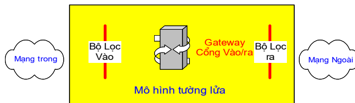
Hình 3-22: Mô hình logic của tường lửa
