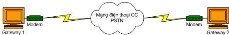
Hình 3-4: Mô hình kết nối dùng một đường điện thoại
