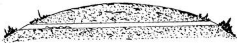
Hình 20 - Nếu đào được một con đường ngầm nối Lêningrats với Mátxcova thì đoàn tàu sẽ chạy đi về trên đường đó rất nhanh nhờ trọng lượng của chính nó chứ không cần đầu máy.
