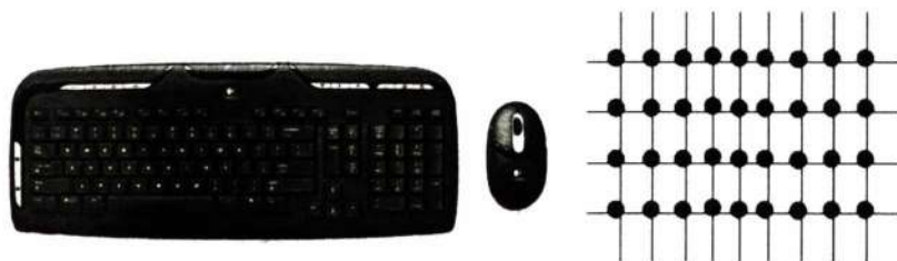
Hình 3.39. Bàn phím và dạng mạch bàn phím
