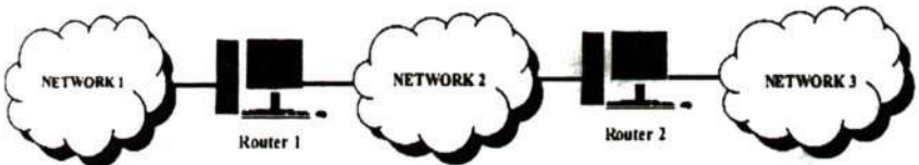
Hình 4.23. Các mạng Network 1, Network 2 và Network 3 kết nối với nhau thông qua router
