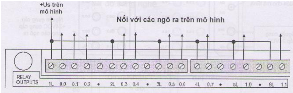
Hình 6.5: Cách kết nối các ngõ ra của PLC với các ngõ ra trong mô hình.
