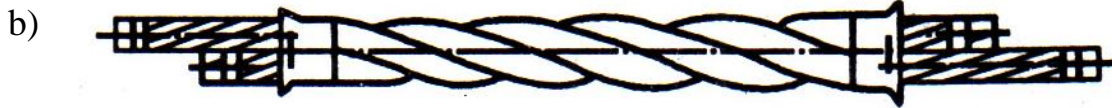
Hình 2-5 .a) Trình tự ép ống nối ô van cho dây đồng, dây nhôm và dây nhôm lõi thép. b) Dạng vặn xoắn của ống nối ô van.
