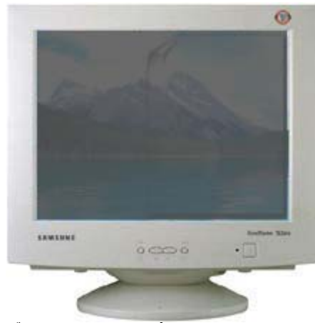
Ảnh bị mờ do mất điện áp lệnh Contrast
