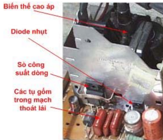
Vị trí sò công suất dòng gắn trên tấm tản nhiệt quanh cao áp
