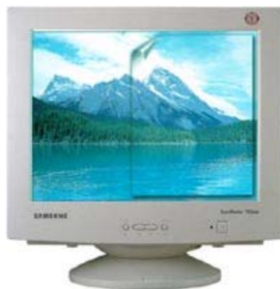
Hỏng tầng công suất R, màn ảnh bị mất màu đỏ
