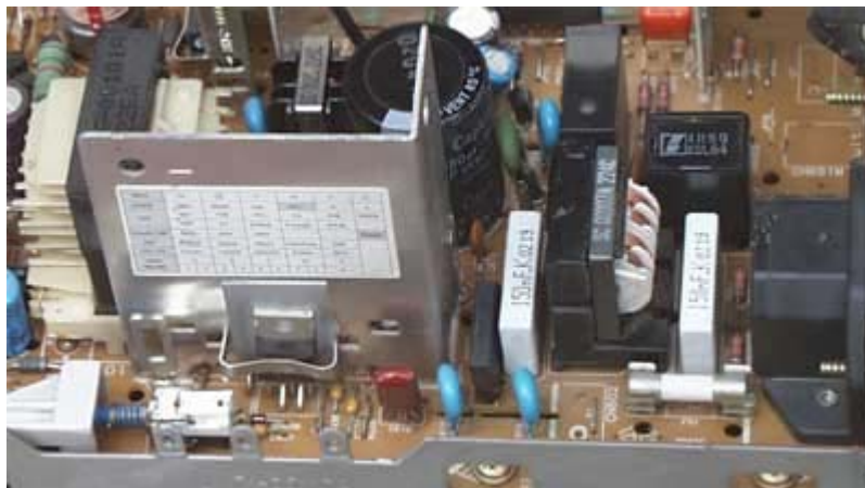
Ảnh chụp bộ nguồn Monitor Samsung Synmaster sử dụng IC công suất
