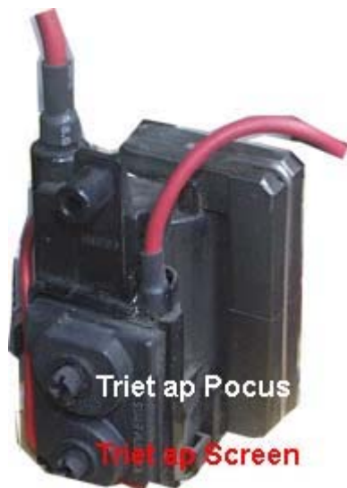
Triết áp Pocus chỉnh điện áp cung cấp cho lưới G3 Triết áp Screen chỉnh điện áp cung cấp cho lưới G2
