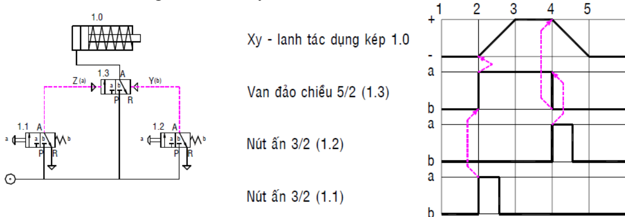
Hình MĐ17-06-16 - Mạch điều khiển gián tiếp xy- lanh tác dụng đơn có phần tử nhớ.
