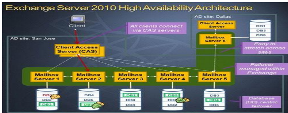
Hình 4.3: Mô hình HA của Exchange Server 2010
