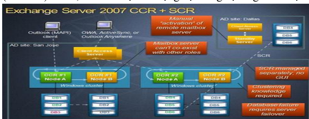
Hình 4.2: Mô hình kiến trúc HA (tính sẵn sàng cao) của Exchange Server 2007
