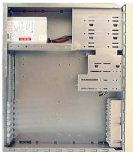
Bên trong Case chỉ có bộ nguồn và các giá đỡ Mainboard, ổ đĩa
