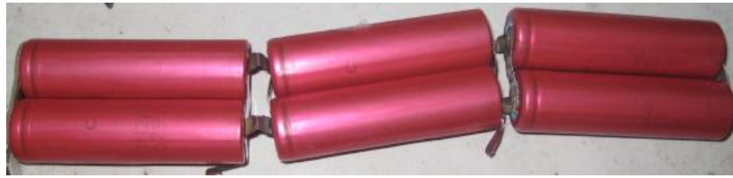
Hình 10.12: Các Cell PIN mắc song song hoặc nối tiếp
