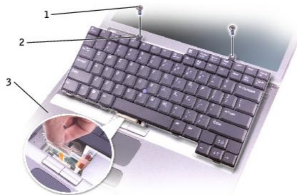
Hình 1.34: Tháo dây kết nối bàn phím
