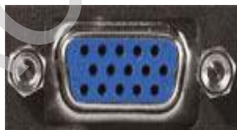
Hình 1.18: Khe cắm VGA
