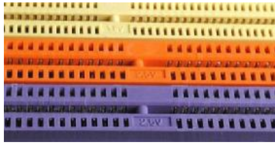
Hình 5.33: Điện áp ghi trên Slot RAM DDR và DDR II
