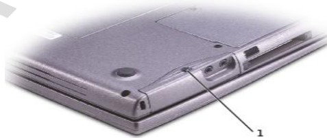
Hình 1.45: Tháo ốc giữ HDD
