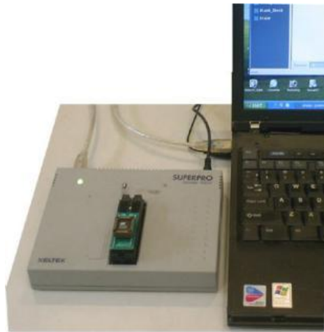
Hình 9.6: Kết nối máy nạp với máy tính
