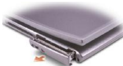
Hình 1.46: Rút ổ HDD ra khỏi Laptop
