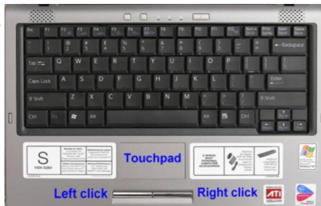
Hình 1.14: Bàn phím và chuột cảm ứng laptop
