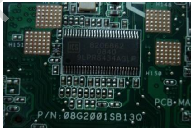
Hình 2.15: IC Clock Gen Laptop
