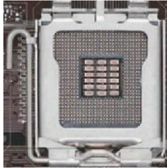
Hình 2.7: Socket 775 Intel (Desktop & Laptop)
