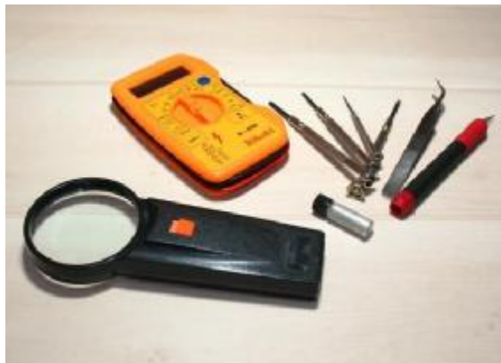
Hình 1.29: dụng cụ tháo lắp laptop
