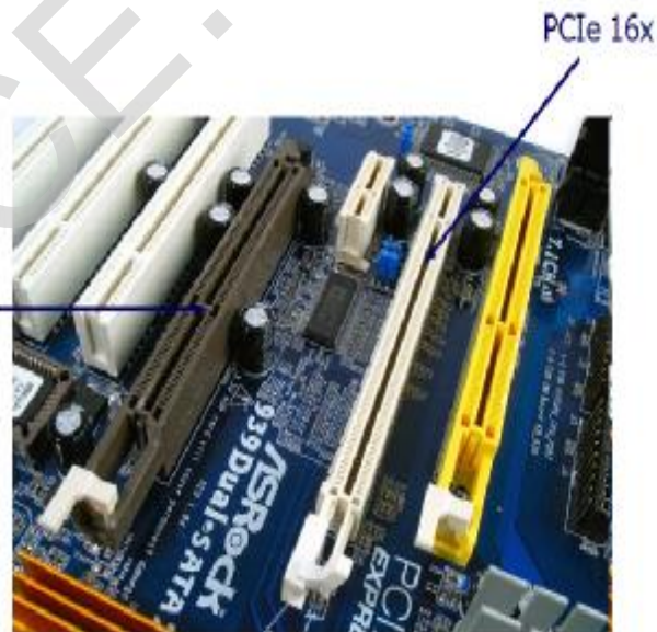
Hình 5.49: Khe cắm AGP và PCIe x16
