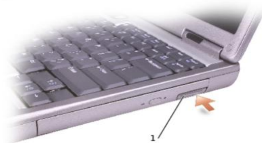
Hình 1.47: Bật chốt giữ ổ đĩa quang
