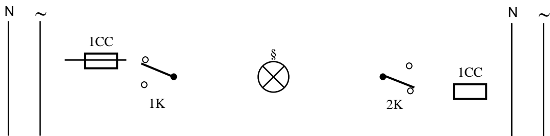
Hình 3-12 Sơ đồ nguyên lý mạch đèn cầu thang
