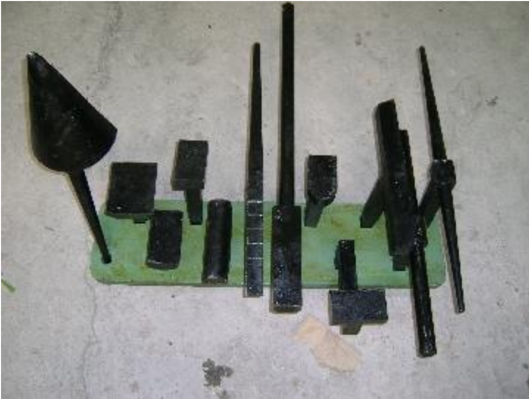
Hình 1.3. Bộ đe có 12 hình dạng khác nhau
