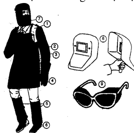
Hình 1.8: Trang bị bảo hộ của thợ hàn khi hàn.
