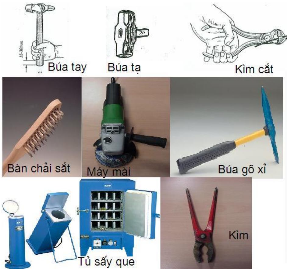
Hình 2.21: Các thiết bị, dụng cụ sử dụng trong nghề hàn
