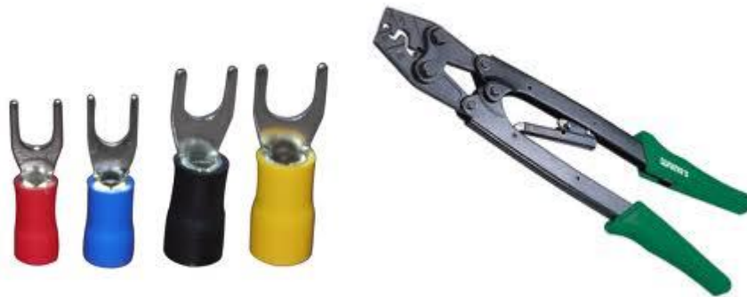
Hình 1.15: Kìm và cốt dùng trong bảng mạch.
