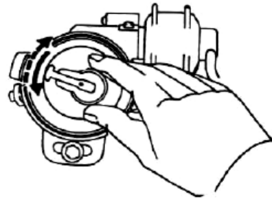
Hình 6.14 Kiểm tra bộ điều chỉnh góc đánh lửa sớm ly tâm.
