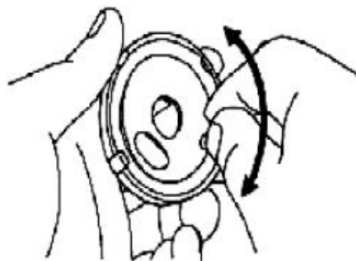
Hình 6.12 Kiểm tra mâm chia điện.
