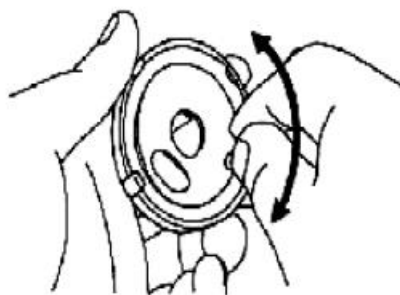
Hình 6.12 Kiểm tra mâm chia điện.
