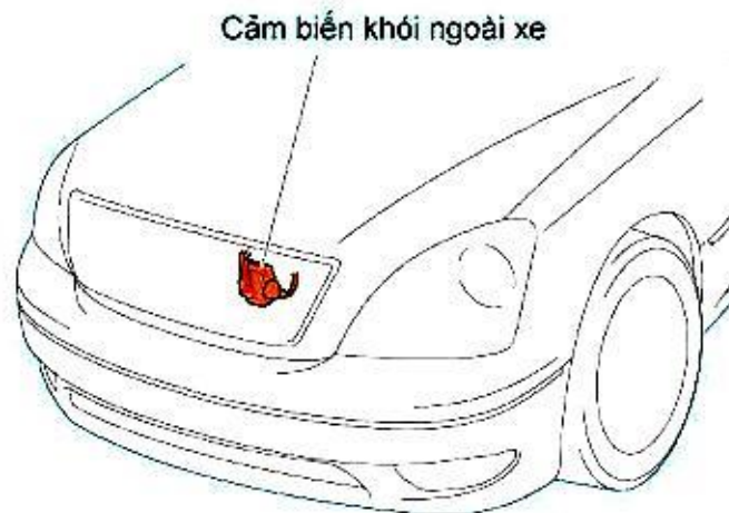
Hình 1.54. Cảm biến ống dẫn gió, cảm biến khói ngoài xe.
