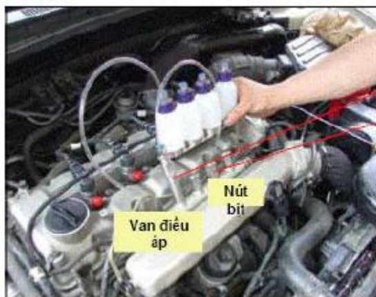
Hình 3.26: Kiểm tra áp suất phun lớn nhất
