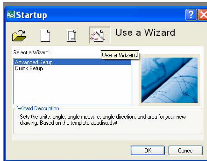
Hình 1.9. Chọn Advanced Setup/ Ok (bạn chọn tuần tự như trong hình). Trong hộp thoại Advanced Setup , thẻ Units chọn Decimal phần Precision chọn 0.00 . Tiếp chọn Next , thẻ Angle có dạng
