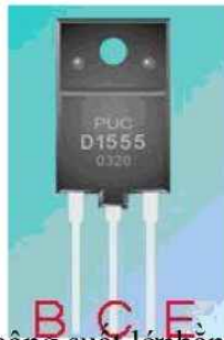
Hình 9.6: Xác định chân BJT công suất lớn bằng quan sát.
