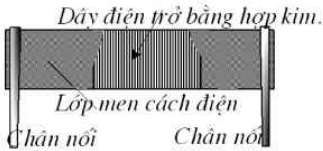
Hình 1-5: Điện trở dây quấn
