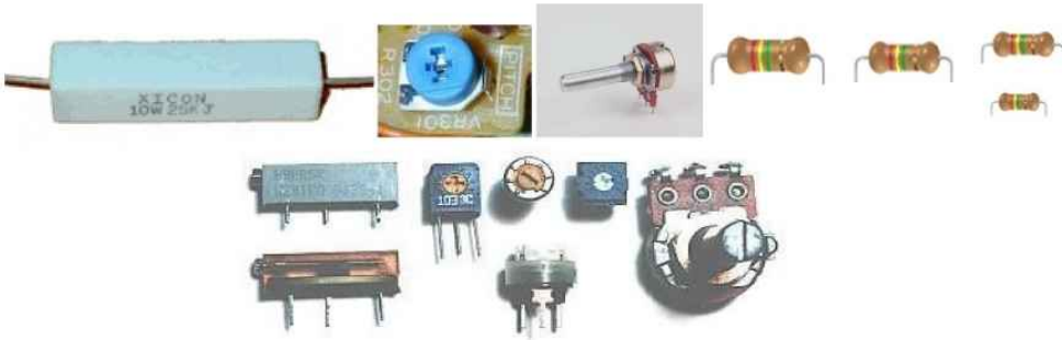
Hình 1.1.b: Hình dạng bên ngoài của một số loại điện trở.
