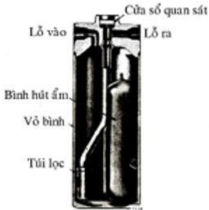
Hình 1.35: Cấu tạo của bình lọc và hút ẩm
