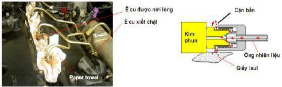
Hình 5.20. Xả nhiên liệu và chặn bần ra khỏi ống cao áp và vòi phun.
