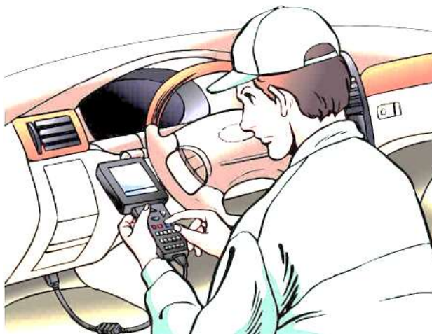
Hình 9.7. Sử dụng hiệu quả máy chẩn đoán để khắc phục hư hỏng
