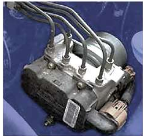
Hình 7.14. Sơ đồ bộ chấp hành thủy lực
