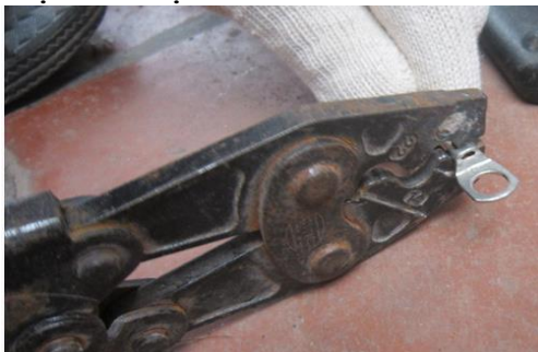
Hình 2.15. Cáp điện sau khi được bấm đầu cốt
