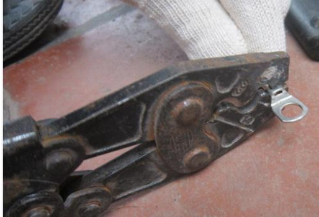
Hình 3.11. Bấm đầu cốt
