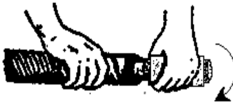
Hình 2.14. làm sạch lõi dây bằng giấy giáp
