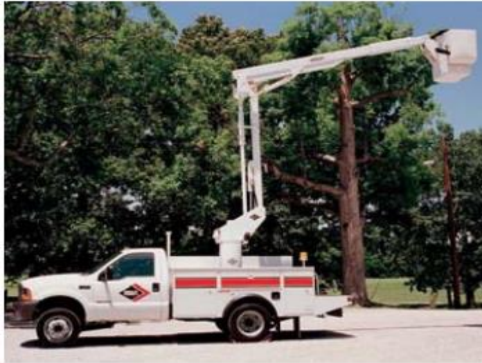
Hình 3.6. Xe nâng chuyên dụng
