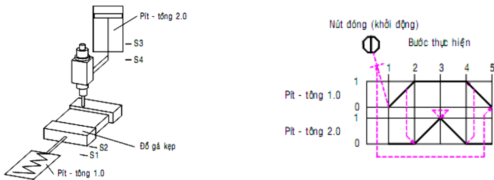
Hình 6.12. Nguyên lý làm việc của máy khoan
