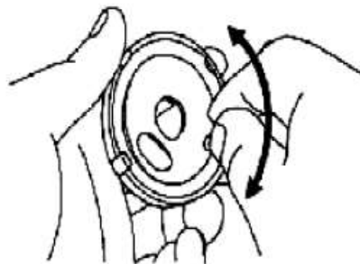
Hình 6.12 Kiểm tra mâm chia điện.
