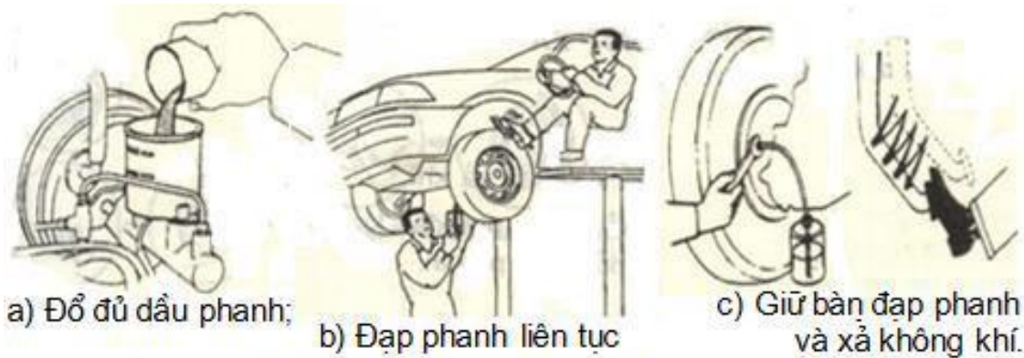
Hình 3.3. Xả không khí trong hệ thống phanh thủy lực
