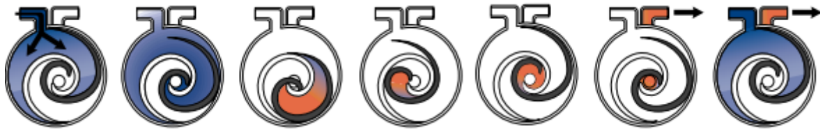
Hình 2.4 .Sơ đồ nguyên lý hoạt động máy nén kiểu xoắn ốc
