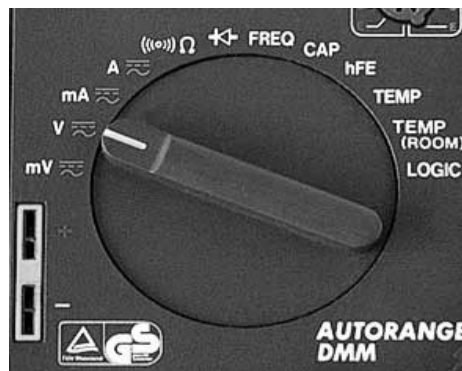
Hình 9.27: Đặt đồng hồ vào thang đo điện áp DC hoặc AC
