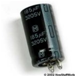
Hình 1.36: Tụ hoá ghi điện dung là 185 \mu\text{F} / 320 \text{V}
