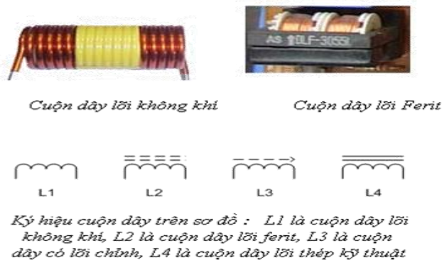
Hình 1.15: Ký hiệu, hình dáng cuộn dây
