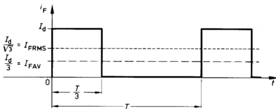
Hình 2.3 Đồ thị thời gian dòng thuận của diode, giá trị trung bình và hiệu dụng
