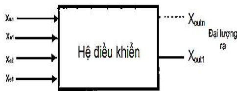
Hình 1.7 Định nghĩa hệ điều khiển hở
