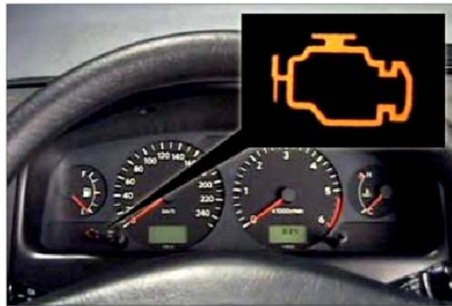
Hình 6.2. Đèn kiểm tra động cơ
