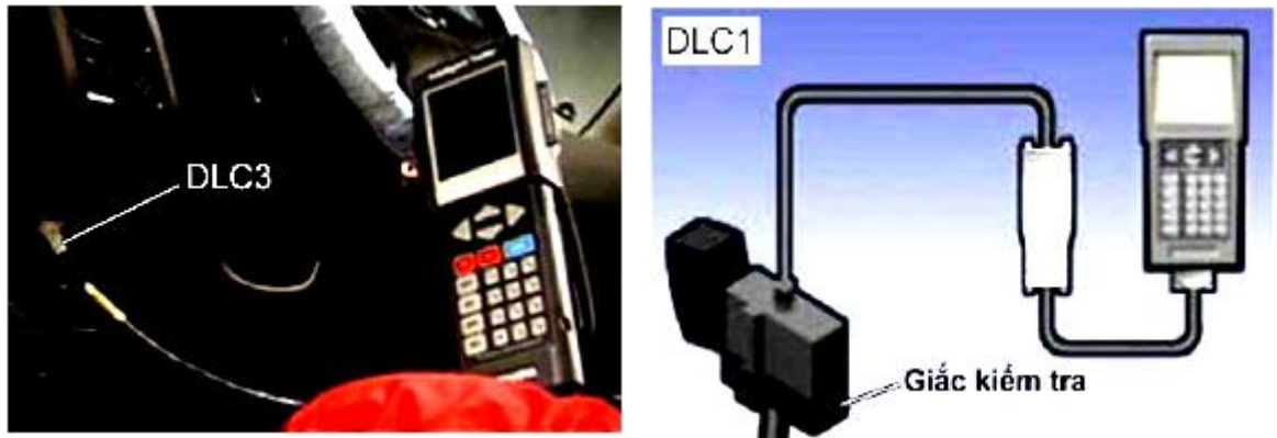
Hình 6.3. Đọc mã lỗi bằng thiết bị
