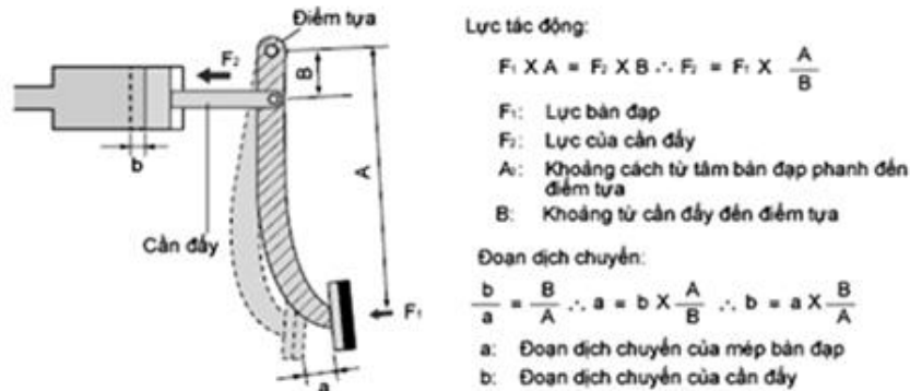
Hình 1.1 Nguyên lý đòn bẩy áp dụng vào bàn đạp phanh
