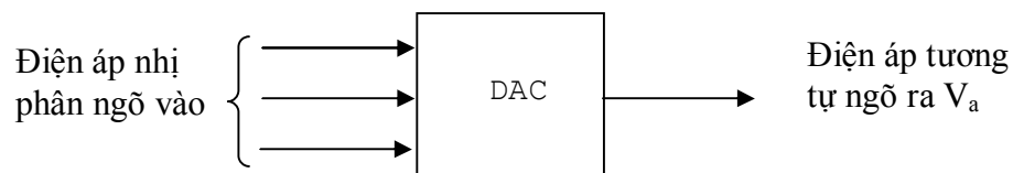
Hình 24-07-1: Sơ đồ khối bộ chuyển đổi DAC
