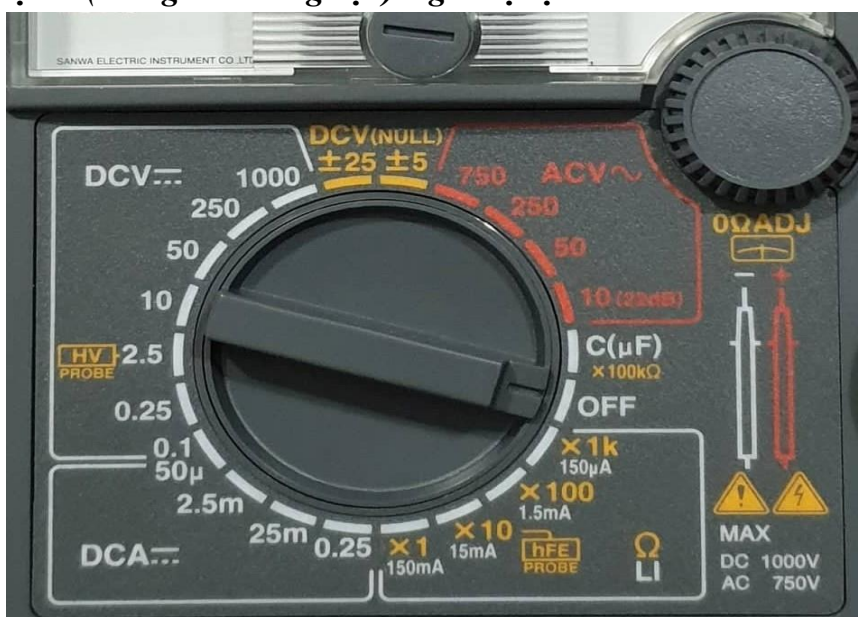
Hình 2.11. Chia thang đo dòng điện trên đồng hồ vạn năng kim
