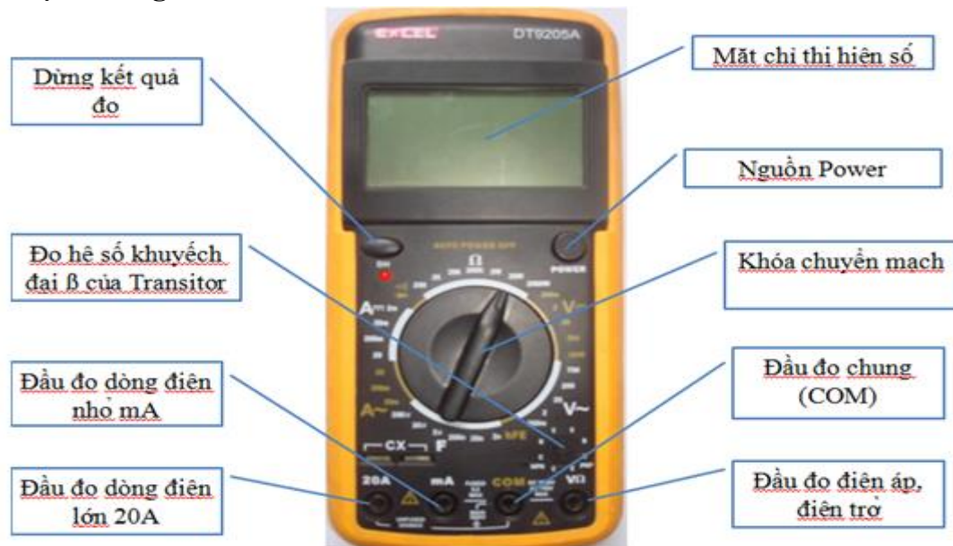
Hình 2.1. Cấu tạo mặt đồng hồ vạn năng hiển thị số EXCEL-DT9205A
