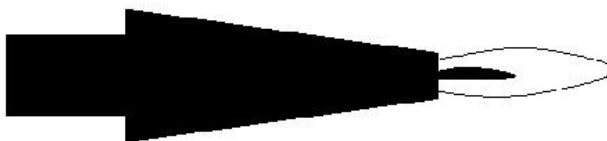
Hình 2.4. Ngọn lửa hàn ô xy hóa.
