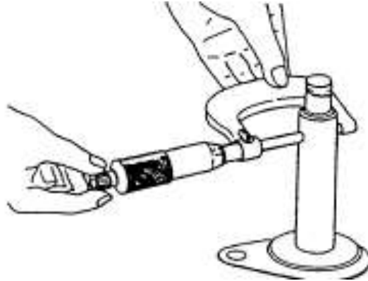
Hình 3.2. Kiểm tra chốt nhíp
